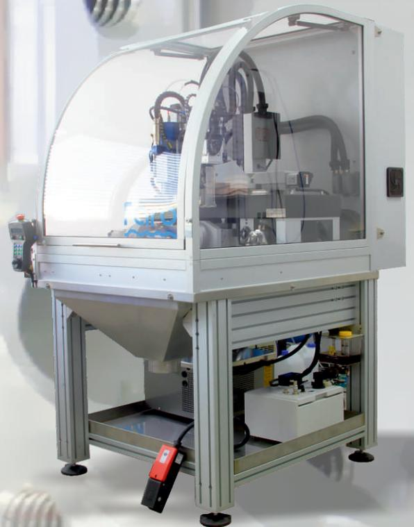
La F35 è la fresatrice a 7 assi più versatile ed evoluta nella classe delle macchine a CN compatte per tutte le lavorazioni di incisione, diamantatura, foratura e pre-
